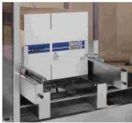
Angetriebenes Flachkartonmagazin - leicht zu befüllen, keine Produktionsunterbrechung.
