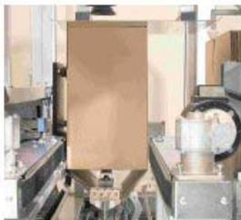
*Genau und betriebssicheres Falten, Beileimen und verschließen von Bodenklappen.*
