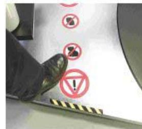
*Sicherheitsschalter in der Bodenplatte eingebaut.*
