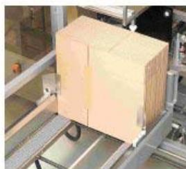
*Angetriebenes Flachkartonmagazin - leicht zu befüllen, keine Produktionsunterbrechung.*
