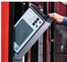
*Der Palettierroboter ist mit einem modernen IPC-Controller ausgerüstet. Dieser ist schwenkbar in einer der beiden Säulen des Roboters untergebracht und wird bei Nichtgebrauch ganz einfach eingeklappt.*
