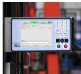
*Der Palettierroboter ist extrem einfach zu bedienen und kann bequem auf unterschiedliche Palettenmuster rekonfiguriert werden. Die Software basiert auf Windows, und die IPC kann zur Steuerung beliebiger externer Ausrüstung wie beispielsweise Palettenbahnen, Palettenmagazine o.Ä. eingesetzt werden.*
