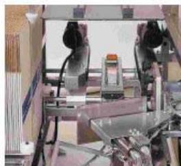
Genaueres und betriebssicheres Falten und Verschließen von Bodenklappen.
