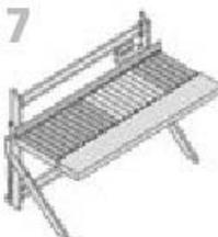
**Rollenbahntisch mit integrierter Digital-Paketwaage, eichfähig**
