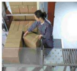
Auf der Beladeplatte bildet die Bedienungsperson das gewünschte Muster.
