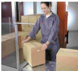
Der Kugeltisch erleichtert die Übertragung auf die Beladeplatte (Zubehör).
