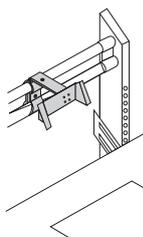
**Halterung für Waagenanzeigergerät**
